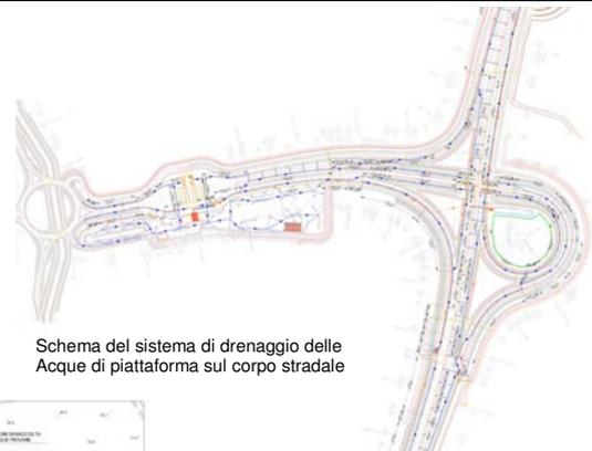
Schema del sistema di drenaggio delle Acque di piattaforma sul corpo stradale
