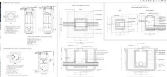
Particolari tipo dei manufatti di ispezione per condotte in PEAD, e manufatti di transizione tra tratti in pressione e a gravità
